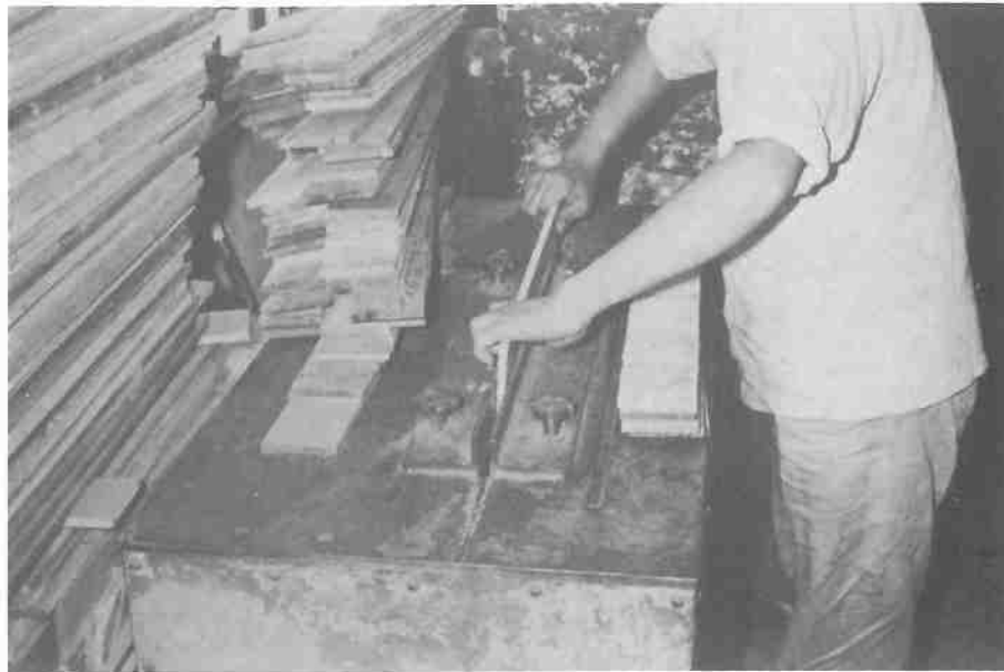
Fig. 14 - Placas-guia ajustadas a uma máquina de mandril, numa fábrica de caixas, para ajudar um operador cego a posicionar a madeira a ser trabalhada. (Foto: cortesia da Hong Kong Society for the Blind)
