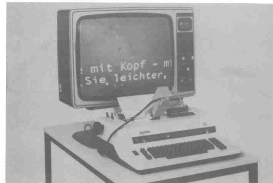
Fig. 8 - Aplicação de textos por meio de uma pequena câmera de vídeo e controle de painel. (Foto: cortesia de Reinecker Videotechnik, Bickenbach, Alemanha)
