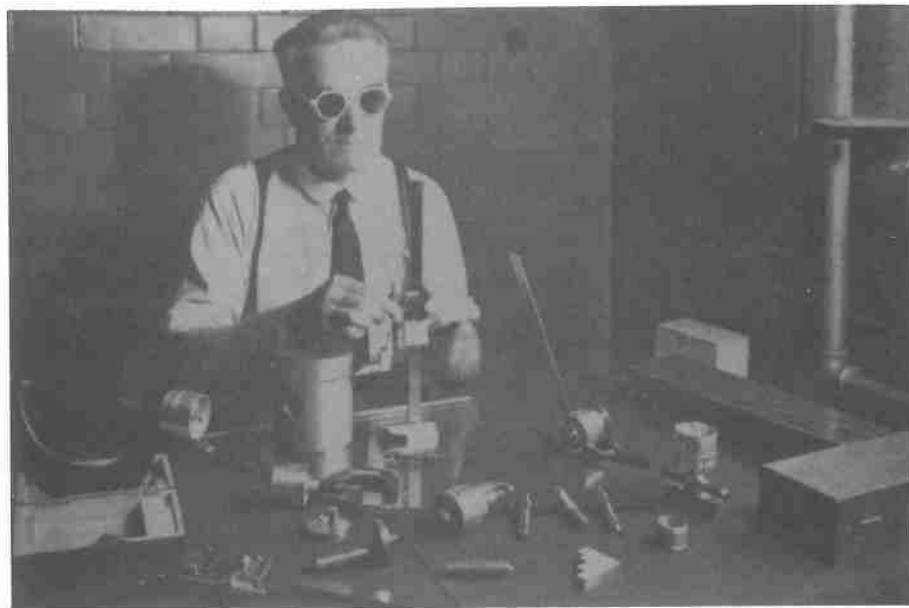
Fig. 10 - Série de instrumentos de precisão com sinais Braille para uso, em inspeção técnica, por trabalhadores cegos. (Foto: cortesia do Royal National Institute for the Blind, Londres, Reino Unido)
