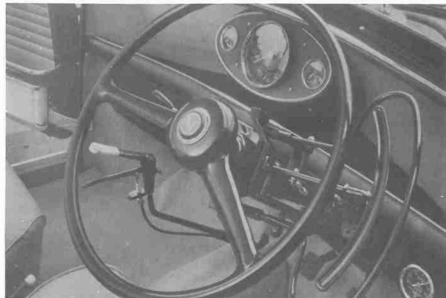
Fig. 36 - Conversão de controles de pé em controles manuais num carro para uso de motorista sem perna. ▽
