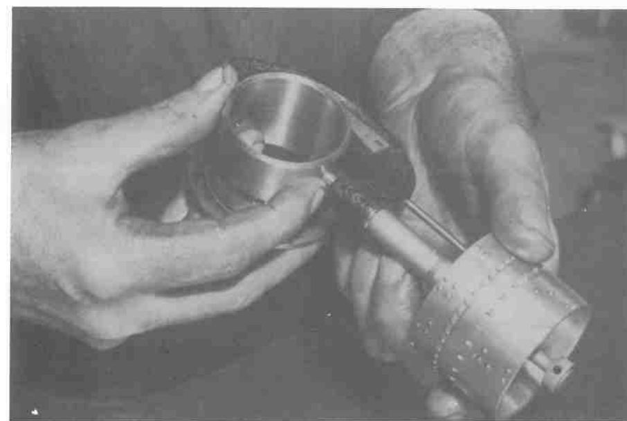
Fig. 9 - Micrômetro com sinais Braille (Foto: cortesia de Royal National Institute for the Blind, Londres, Reino Unido)
