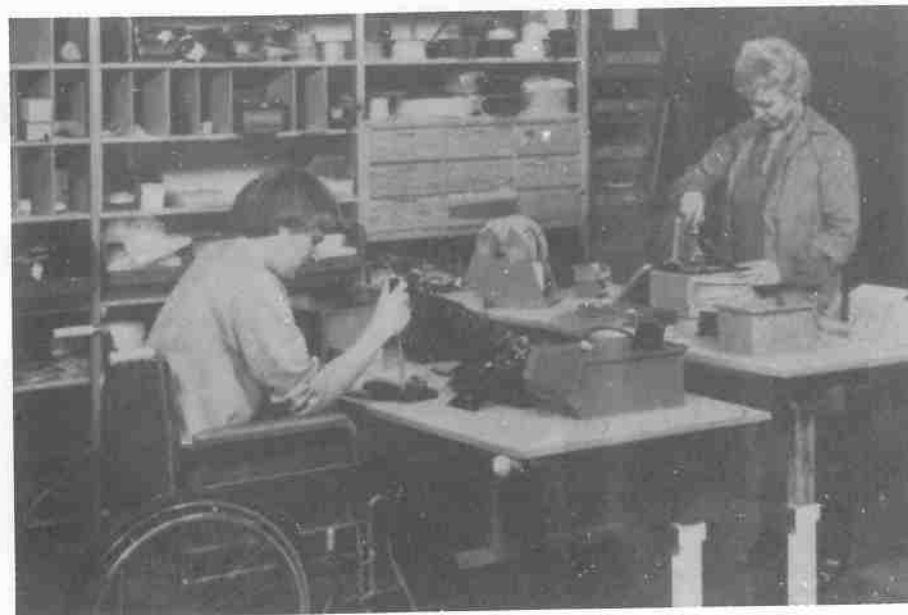
Fig. 44 - Dispositivo ajustável para rebaixar o plano de trabalho para uso em posição de pé ou assentado. (Foto: cortesia do Instituto Sueco para Portadores de Desvantagens) ▷
