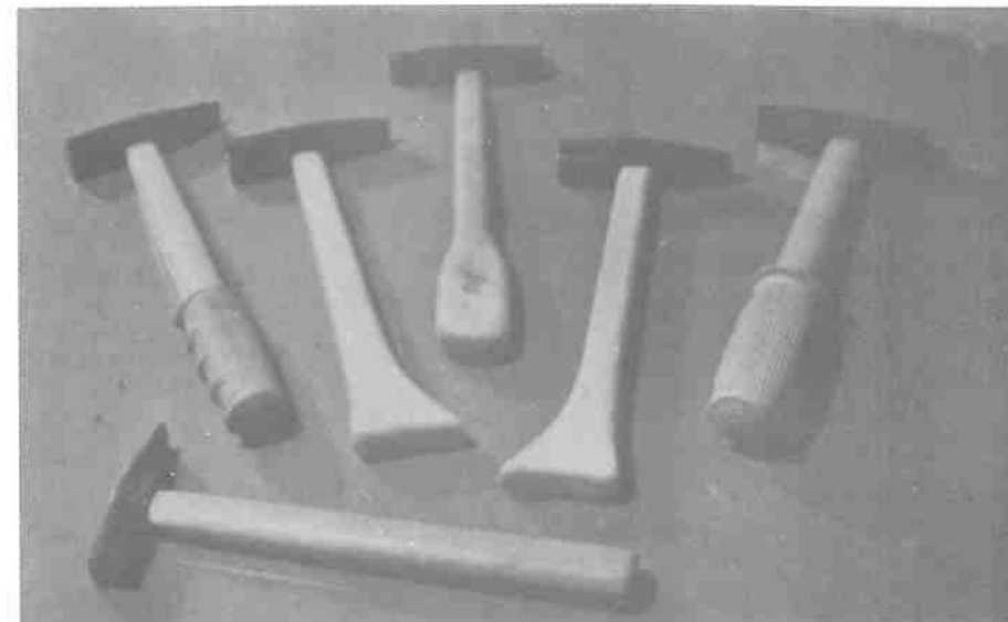
Fig. 33 - Diferentes formas de cabos de martelo para uso de pessoas com fraca pressão manual. (Foto: cortesia do Centro de Reabilitação Industrial da Academia Médica, Poznam, Polônia)
