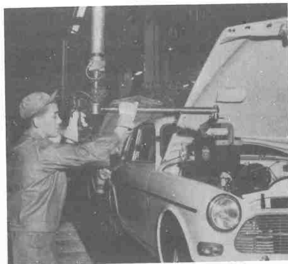
▷ Fig. 27 - Dispositivo pneumático para levantar e transportar baterias ao longo de um monotrilha na montagem de automóvel. (Foto: cortesia de AB Volvo, Göteborg, Suécia)
