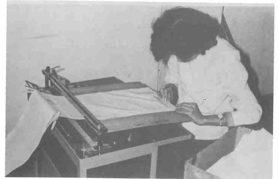
Fig. 16 - Tábua medidora de madeira compensada para capacitar um operador cego a cortar sacos plásticos no comprimento desejado. (Foto: cortesia da Hong Kong Society for the Blind)
